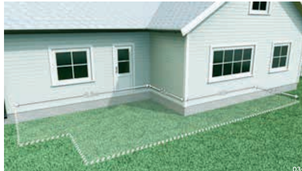
03-2 Finn ut av hvor stor og hvilken form terrassen skal ha. Her kan du bruke Monters terrassekalkulator. Velg om terrassen skal gå rett ut fra terrassedøren eller være ett trinn ned, noe som gjør det enklere å få opp døren når det er snø foran.
